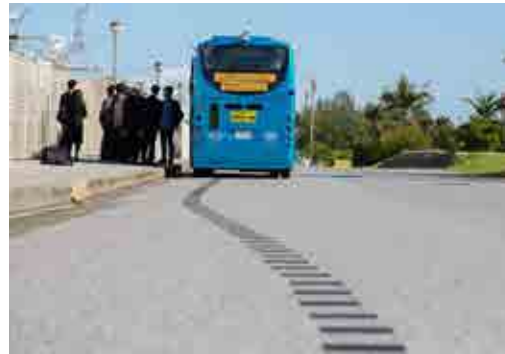
準天頂衛星・磁気マーカー等の 技術を織り込み、正着制御等の ロバスト性を向上
