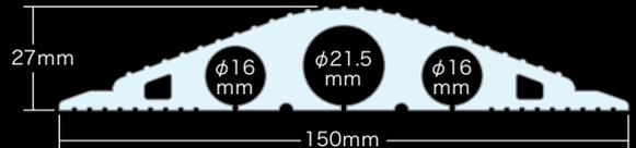
【適応電線】※装飾用点滅灯収納時は車両による踏み付け不可
