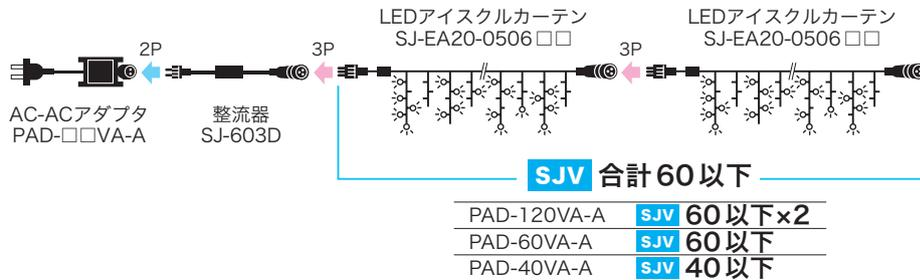
※LED側で点滅を制御する自己点滅型LEDは全点灯と同様に常時電気を供給する必要があります。従って制御には整流器を使用してください。コントローラーを使用の場合は、本来の効果が得られません。
