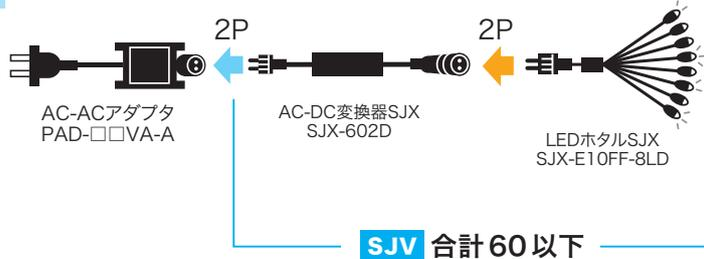
※AC-DC変換器SJX (SJX-602D) のみ使用可能です。SJVを21.0消費しますので、LEDホタルSJXのSJVと足して60以下になるように接続してください。他のコントローラ・整流器では使用できません。
